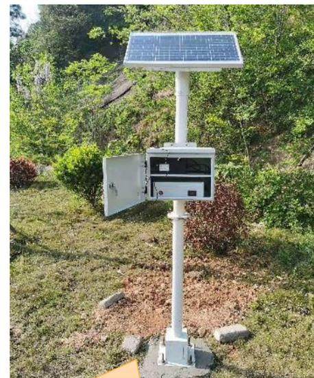
太阳能发电装置供电，支持连续10个阴雨天供电
