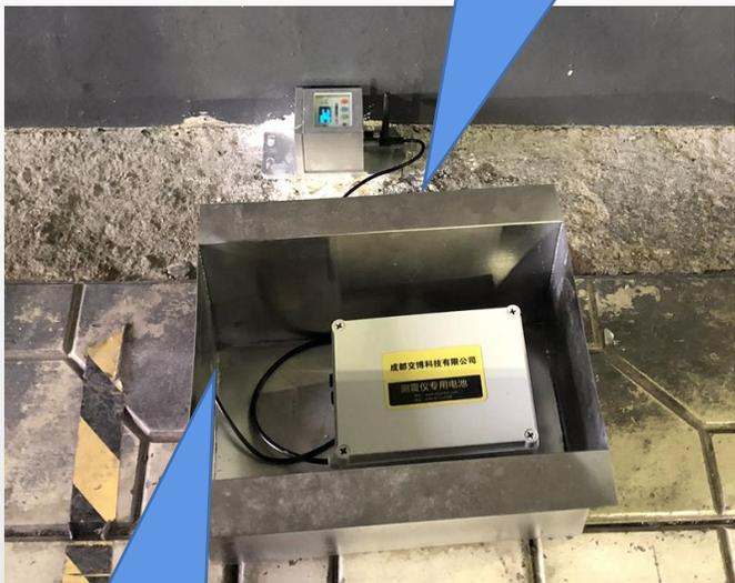
将直流电池放入防护箱，从缺口引出充电线
