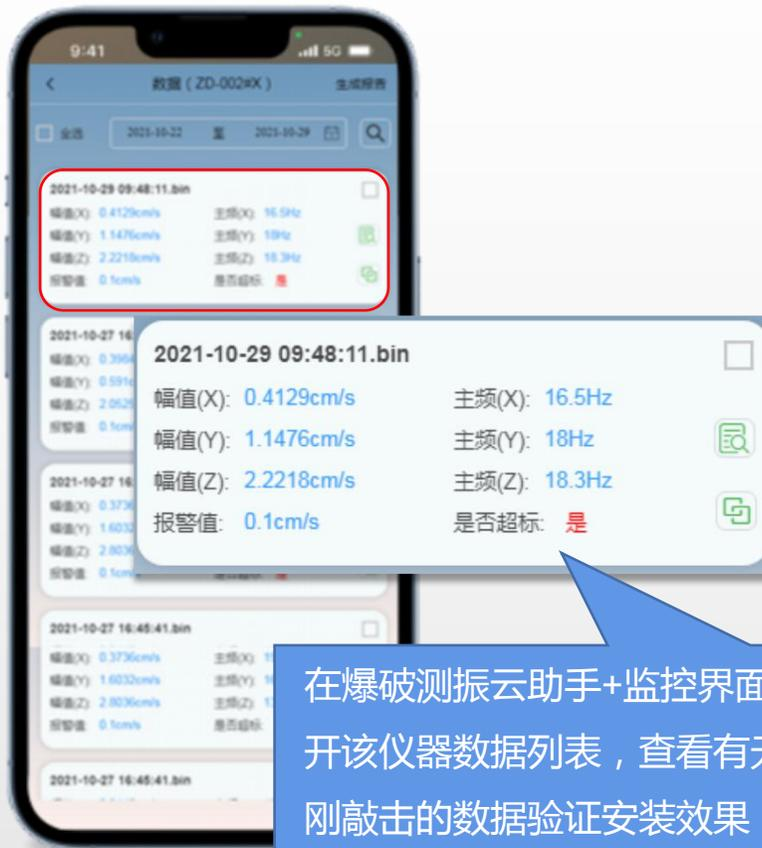
在爆破测振云助手+监控界面打开该仪器数据列表，查看有无刚敲击的数据验证安装效果
