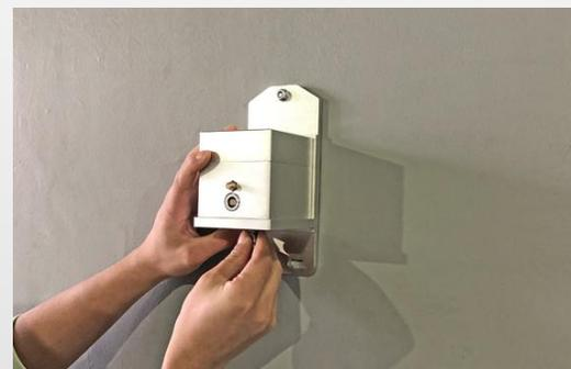
4. 仪器置于夹具上，根据爆源调整方向，螺丝拧紧仪器与夹具
