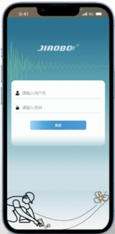
手机助手使用微信小程序的形式内嵌入微信，脱离电脑独立使用，用于对L20-X测振终端进行参数设置和仪器分配，一键生成爆次报告和测点报告，对报告进行下载和分享。
