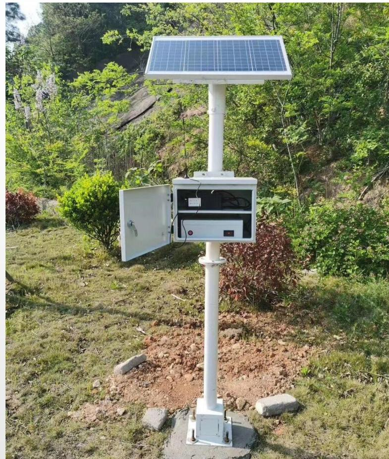
5. 连接太阳能充电板与太阳能锂电池，连接电池与仪器
